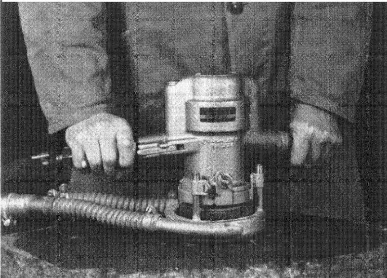
26 Absaugung einer Flächenschleifmaschine durch eine Ringdüse.
