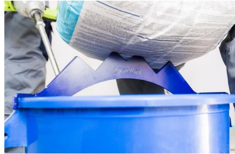
Den Spachtelmassen-Sack mittig auf den UZIN Ripper aufsetzen. Der Sack wird automatisch aufgeschlitzt und das Pulver fällt direkt in den Eimer.
